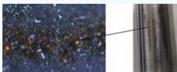
图4 轴承滚动体上微电解腐蚀情况(放大100倍)
