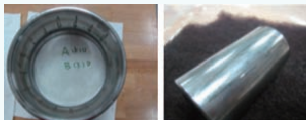
图3 轴承上等滚子间距的微电解腐蚀的现象
