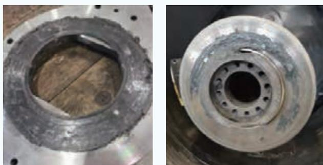
图7 摩擦片磨损
