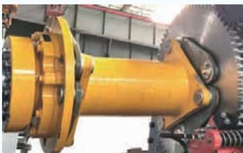
图3 某钢筒焊接工艺风电联轴器
