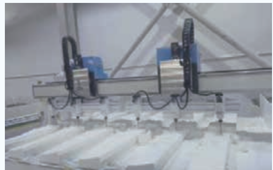
(b) 五轴设备加工的合模泡沫
