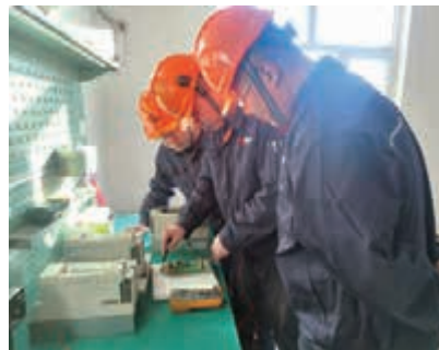
班组成员在检修试验室对变频器IGBT、偏航变频器、变桨变频器等进行测试及试验维修
