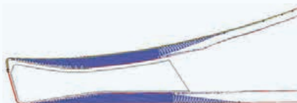
图3 后缘合模泡沫截面基本轮廓
