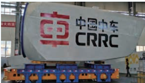
图5 机舱成品转运方式
