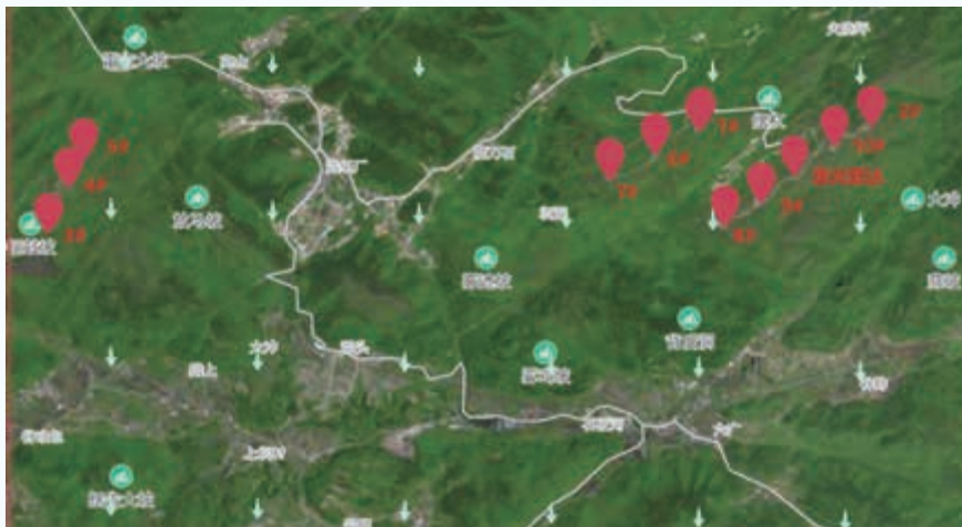
图1 风电场风电机组、激光雷达位置和主风向示意（LiGa风能资源平台截图）
