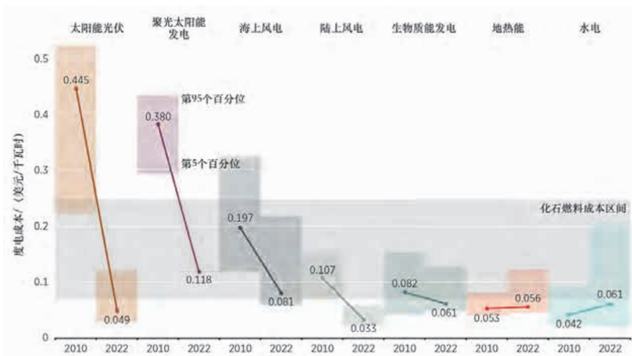
图4 2010—2022年全球公用事业规模可再生能源新增装机的度电成本变化
