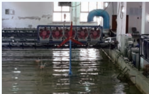
图1 三桩基础海上风电机组实验模型系统 (1: 50缩尺比)
